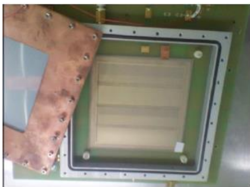
采用热压膜工艺制作的MicroMegas
